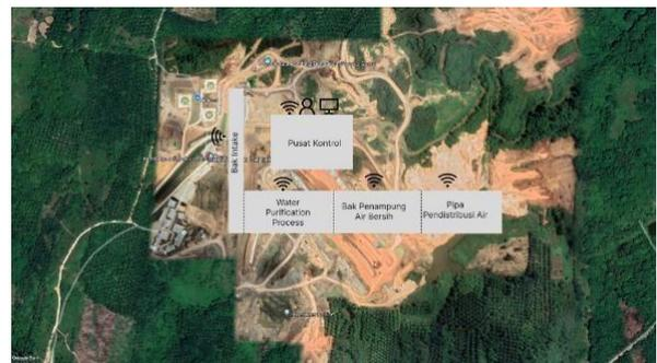
**Gambar 6.** Layout Penerapan Teknologi 5G di Bendungan Sepaku Semoi
