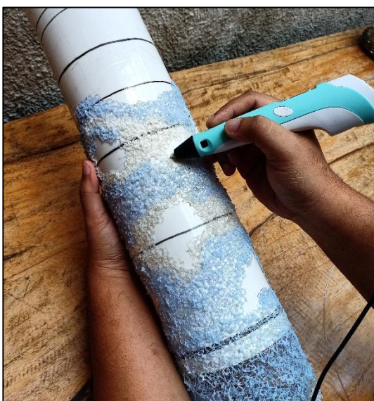
Gambar 8. Pencetakan Motif Filamen PET Menggunakan Cetakan ( Moulding )
