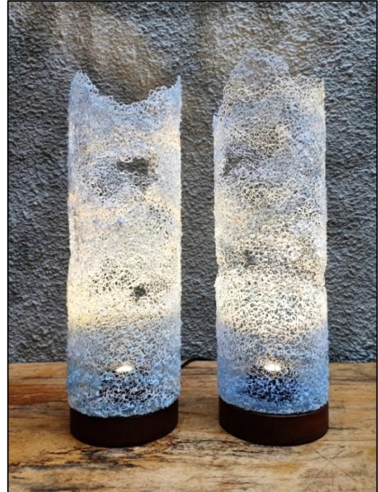
Gambar 9. Hasil Pengolahan Filamen PET Menjadi Lampu Meja Menggunakan 3D Pen
