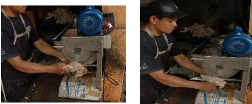
Gambar 7. Proses Operator memotong ayam dengan portable poultry machine (PPM)
