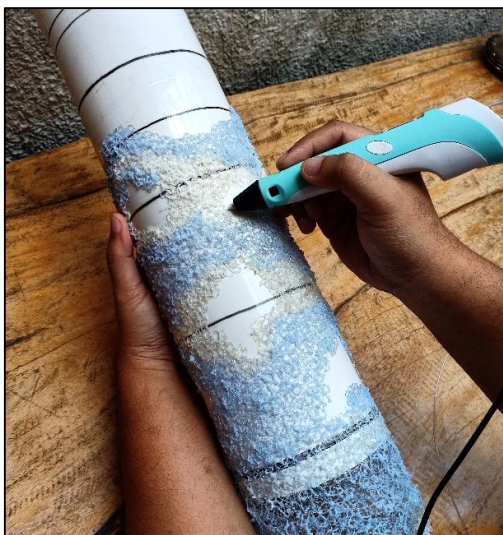
Gambar 8. Pencetakan Motif Filamen PET Menggunakan Cetakan ( Moulding )
