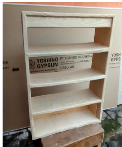
Gambar 6. Rak sepatu dengan bahan dasar material hasil peleburan. Lapisan warna cerah adalah material pelapis yang dapat disesuaikan dengan kebutuhan desain.
