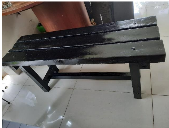
Gambar 7. Kursi kayu yang terbuat dari material hasil peleburan. Untuk menjadikan produk lebih mengkilap maka dilakukan pengecatan.
