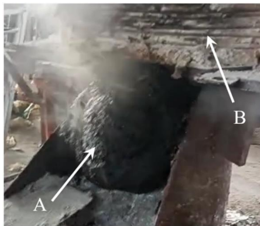
Gambar 3. Material hasil peleburan dicirikan dengan warna hitam dan berbentuk pasta (A) yang keluar dari tungku peleburan (B).
