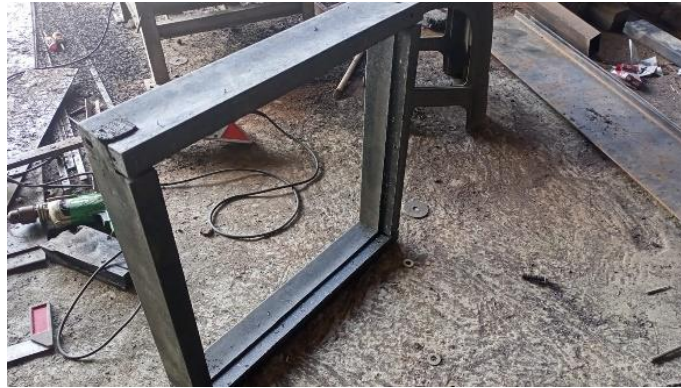
Gambar 8. Kusen atau rangka jendela terbuat dari material hasil peleburan.
