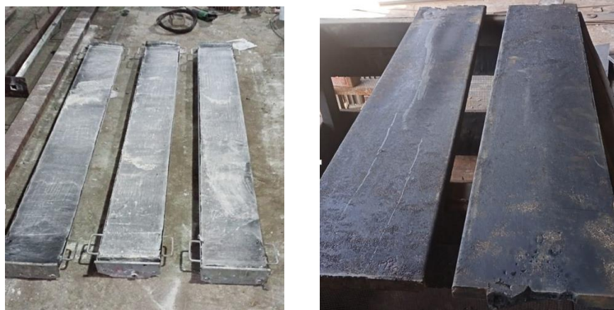
Gambar 5. Produk berupa lembaran papan dari cetakan langsung (kiri) dan cetakan ekstruder (kanan).
