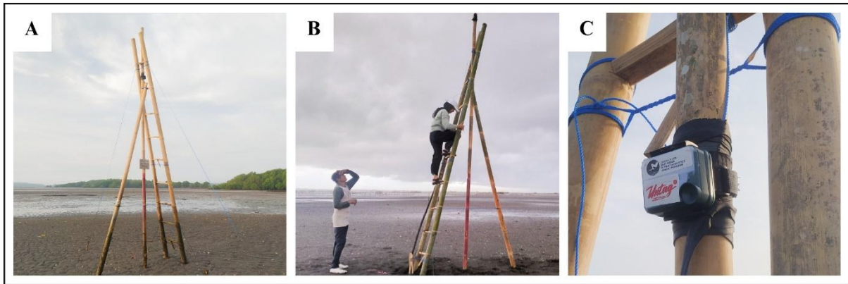
Gambar 3. (A) Desain bambu untuk memasang AudioMoth; (B) Pemasangan AudioMoth;
