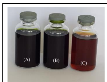
Gambar 3. Larutan hasil ekstraksi daun saga rambat menggunakan etanol (A), metanol (B), dan air (C).
