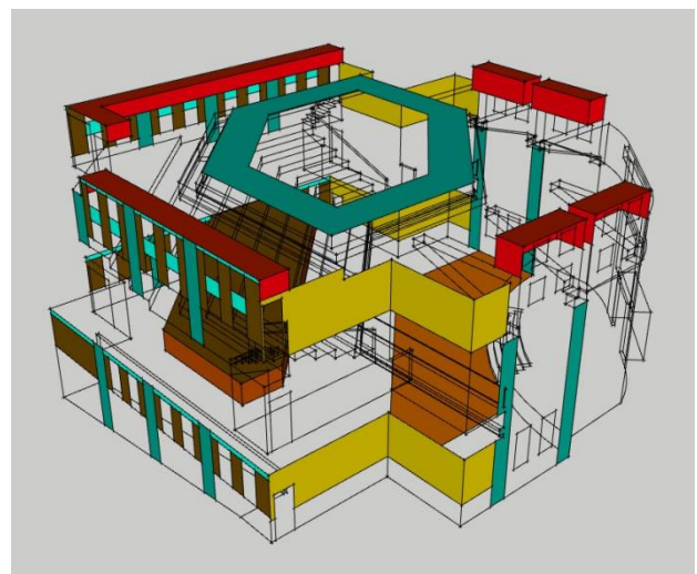
Gambar 7. Peletakan material akustik pada level advance.
