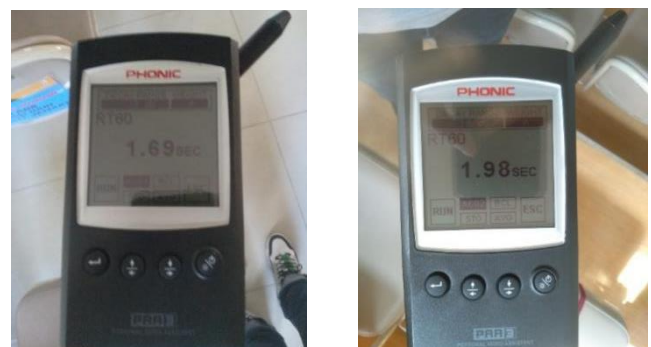
Gambar 1. Hasil pengukuran nilai RT60 di lantai bawah (kiri) dan lantai atas (kanan)
