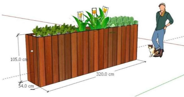
Gambar 14. Model sistem reaktor taman pengolahan limbah sederhana dan desain pelengkapunya.
