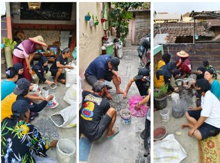
Gambar 15. Penyortiran dan Pencucian Batu berdasarkan Ukuran
