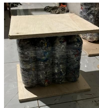
Gambar 5. Furniture Kursi Setelah Ecobrick Direkatkan dengan Solasi dan Lem Epoxy Resin
