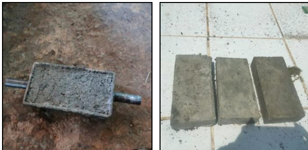
Gambar 7. Uji Coba Pembuatan dan Contoh Produk Eco-Conblock dari Sampah Plastik
