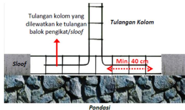
Gambar 11. Hubungan Kolom Praktis dan Sloof [8]
