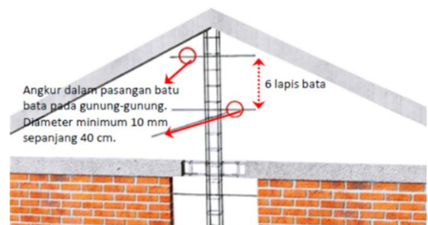
Gambar 6. Detail Angkur pada Gunung-Gunung [8]
