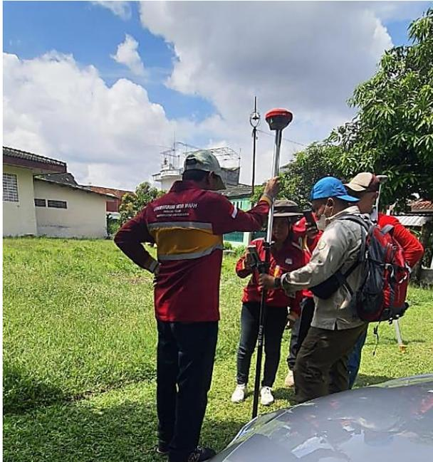
Gambar 4. Pengukuran Elevasi Kawasan dengan GPS Geodetik EFIX 7+
