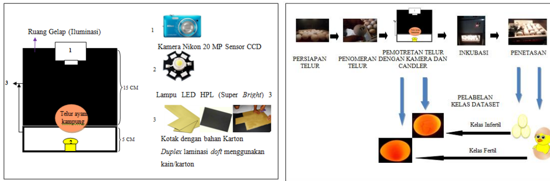
Gambar 1. (a) Ilustrasi dan spesifikasi dari candler telur untuk pengambilan citra candling telur ayam, (b) Proses pengambilan dataset citra candling telur ayam kampung.
