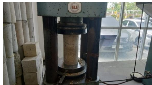
Gambar 1. Contoh Pengujian Tekan Silinder Beton
