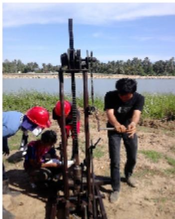
**Gambar 10.** Uji sondir (CPT) pada lokasi proyek pengendalian banjir sungai Batang Anai
