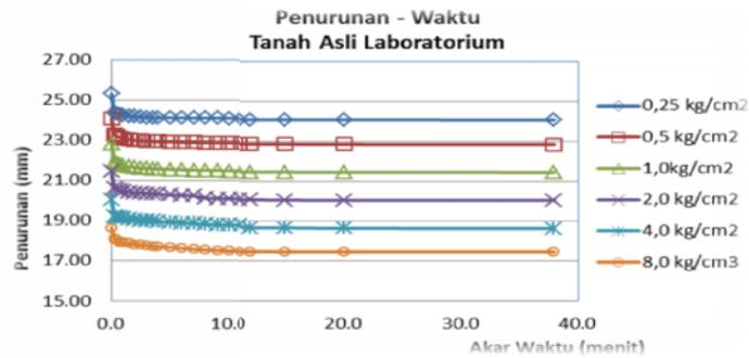
Gambar 5. Grafik Penurunan Vs Waktu (Tanah Asli Laboratorium)
