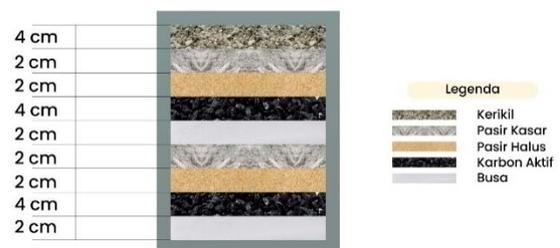
Gambar 2. Spesifikasi filter yang digunakan
