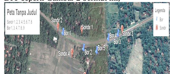
Gambar 2. Denah titik Sondir dan Boring (S2&BH1 dan S4&BH3)
