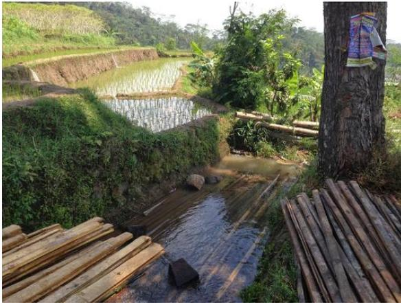
Gambar 6. Proses pengawetan bambu, a. perendaman di sungai mengalir (sumber : Gonzo, 2014 pengolahan bamboo di desa Sekarlangit, Magelang) dan
