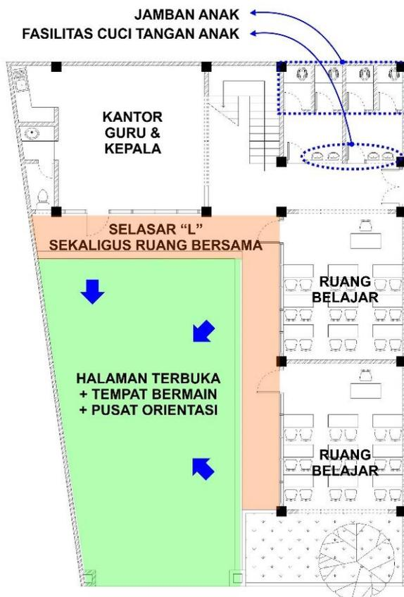
Gambar 1. Konsep Lay Out Lantai Dasar
